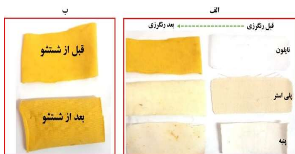
شکل 12. نتایج آزمون رنگ MNP بر روی الف) انواع پارچه قبل و بعد از رنگرزی، ب) پارچه نایلون قبل و بعد از شستشو.
