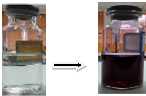
شکل ۱. الف) ۱۰ میلی‌لیتر محلول \text{HAuCl}_4 با غلظت ۰/۵ میلی‌مولار و ب) بعد از اضافه کردن ۸ قطره عصاره پوست سیب قرمز در دمای ۹۵ درجه سانتی-گراد با گذشت مدت زمان ۱ دقیقه.
