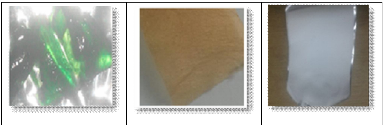
شکل 4. ب- نانو فیبر کیتوسان/پلی-وینیل-الکل (راست)، نانو فیبر کیتوسان/پلی-وینیل-الکل شبکه‌دار شده (وسط)، نانو فیبر کیتوسان/پلی-وینیل-الکل بعد از جذب رنگ‌ها (چپ).
